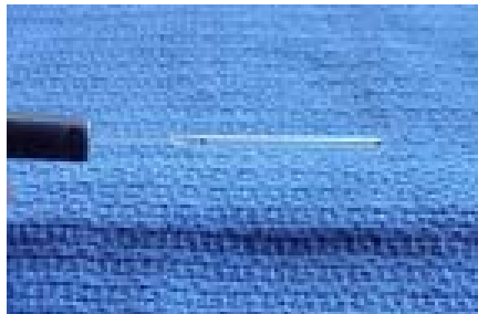
Sợi phân quang hình trụ được dùng để cung cấp năng lượng laser không sinh nhiệt trong quá trình quang động trị liệu.
